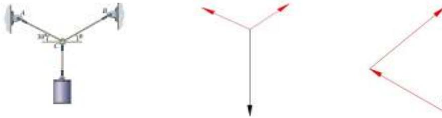
**FIGURA 3. Exercício à esquerda, e Diagrama de corpo livre à direita.**
