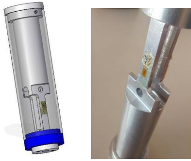
FIGURA 1. (a) Dispositivo proposto e (b) dispositivo com extensômetros colados.
