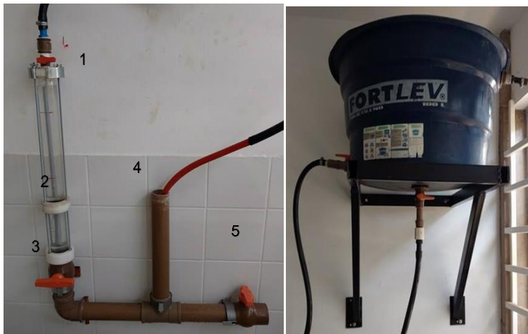
Figura 2 - Ensaio de permissividade realizado no Laboratório de Geotecnia da UFSCar. Fonte: Autoria própria.
