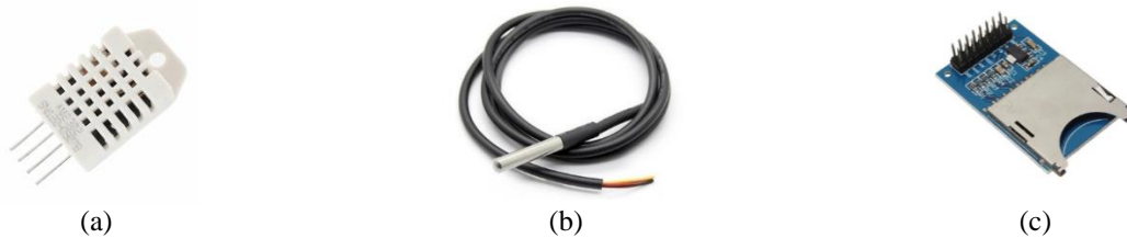
Figura 2 – Sensores, (a) DHT22 (AM2302), (b) DS18B20, e (c) Módulo SD card utilizados neste trabalho. Fonte: Filipeflop, 2015 e Arduino e Cia, 2016.
