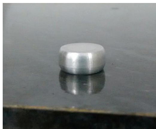
FIGURA 6. Configuração deformada do CP2 (a) imediatamente após o término do ensaio e (b) em ampliação frontal para estudo do “Efeito Barril”.
