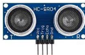
Figura 1 - Sensor ultrassônico, HC-SR04.
