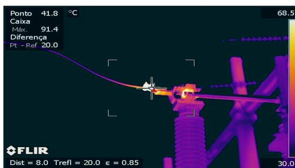
Figura 2 – Termograma evidenciando o forte aquecimento no contato e no conector por condução.
