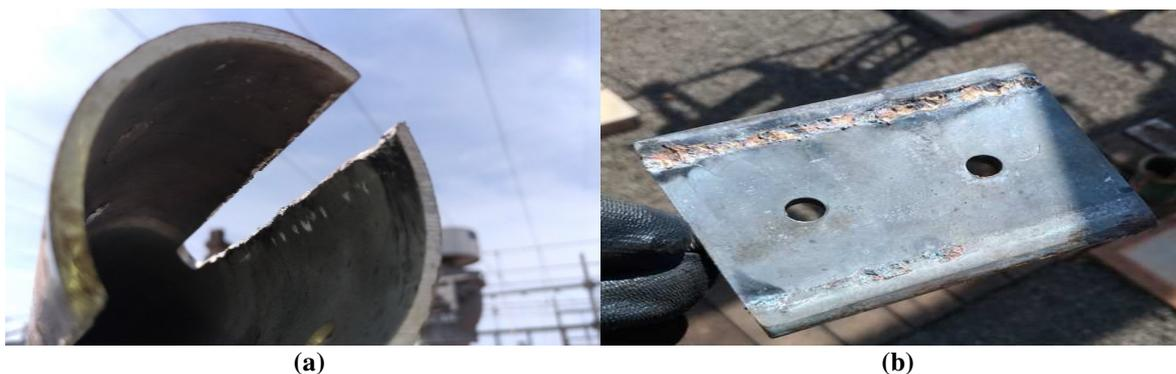
Figura 3 – (a) Tubo de alumínio e (b) chapa de cobre banhada a prata com desgastes.
