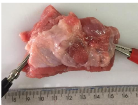
FIGURA 3. Setup experimental para mensurar a impedância e a caracterização por imagem. Fonte: Elaborada pelo autor.
