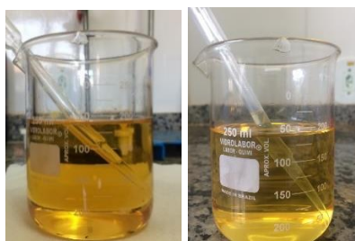
Figura 7 – Biodiesel de algodão (esquerda) e soja (direita) após recuperação do álcool. Fonte: Elaborada pelo autor, 2019.
