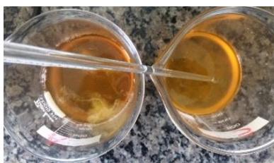
Figura 6 – Biodiesel de algodão (esquerda) e soja (direita) após recuperação do álcool.
