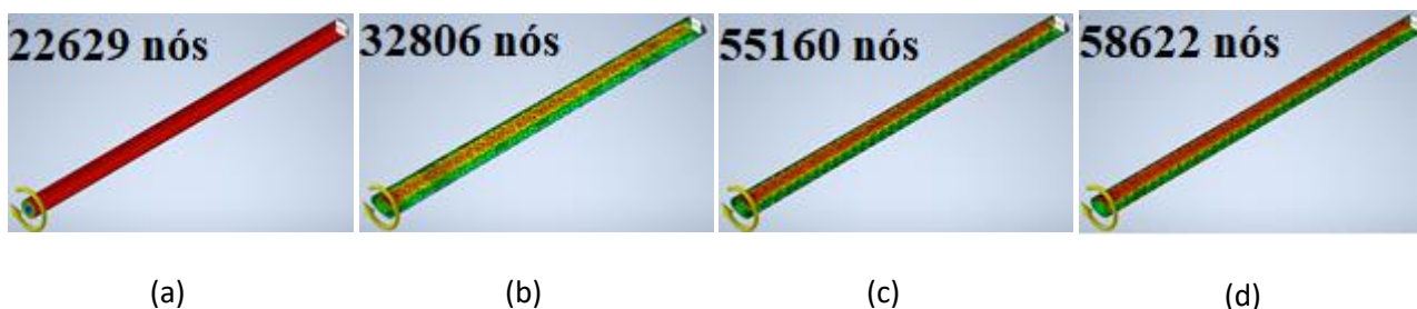
FIGURA 1. Barras a) circular, b) elíptica 1, c) elíptica 2 e d) elíptica 3, na análise por MEF, em vista de malha refinada, com engaste em uma das faces e torque aplicado na face oposta. Fonte: Elaborada pelos autores.
