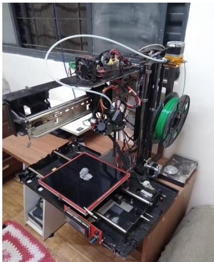
**FIGURA 4. Impressora 3D construída.**
