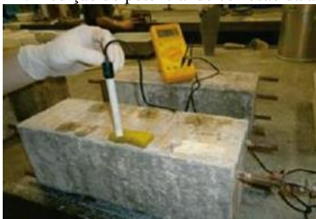
FIGURA 4. Medição do potencial de corrosão da armadura.
