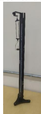
FIGURA 3. Conjunto experimental da lei de Hooke: associação em paralelo de molas de mesma constante.
