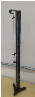
FIGURA 2. Conjunto experimental da lei de Hooke: associação em série de molas de mesma constante.
