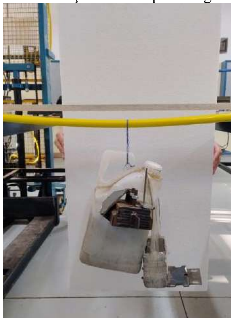
FIGURA 3. Deformação do tubo para carga de 203,95 N
