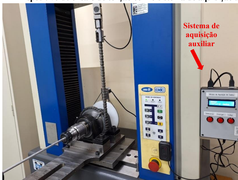
FIGURA 2 – Dispositivo de ensaio de torção com o sistema de aquisição auxiliar.
