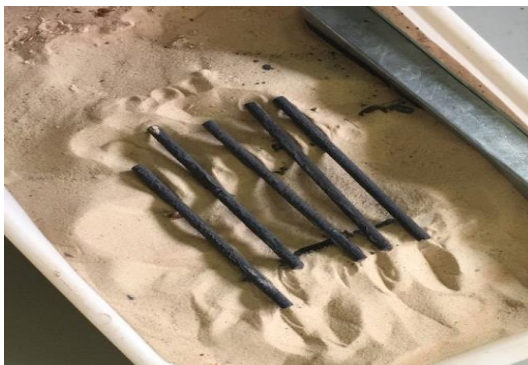
FIGURA 1 - Amostras resfriando ao ar calmo após o processo de revenimento. Fonte: Próprio Autor, 2019.
