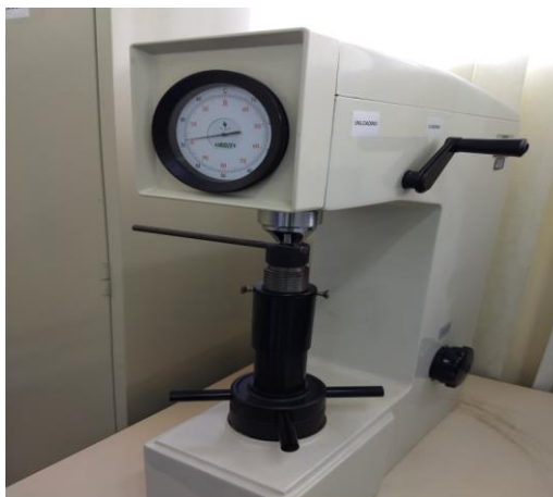
Figura 2 - Equipamento utilizado para o ensaio de dureza. Fonte: Próprio Autor, 2019.
