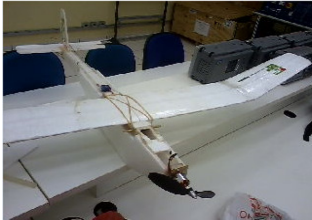
Figura 26 Aeronave modificada com o sistema de estabilização de vôo
